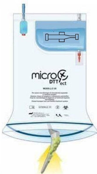
Figura 7: Inserimento dei campioni espuntati all'interno del dispositivo microDTTect
